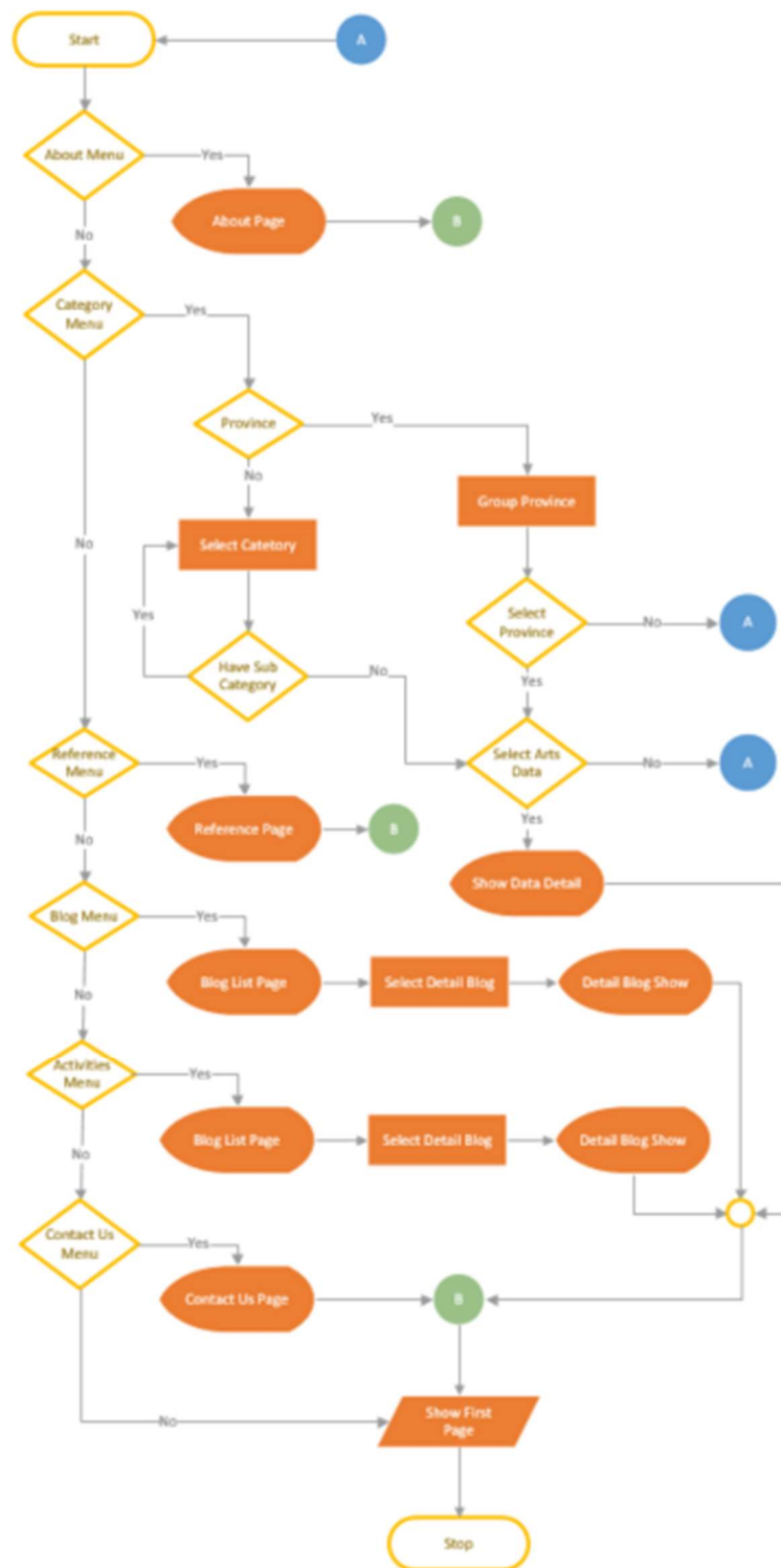
ภาพที่ 27 Flowchart ของระบบส่วน Frontend
