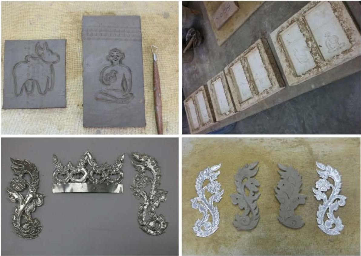
ภาพที่ 23 การสร้างแม่พิมพ์ของการทำกระเบื้องดินเผาและเครื่องประดับบ้านสวย (© Pakit Bunsut 20/01/2018)
