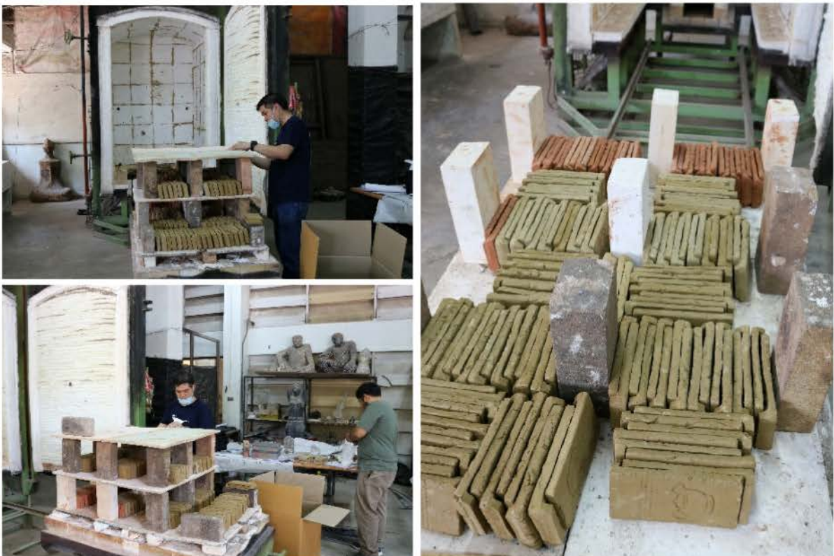
ภาพที่ 24 การเรียงแผ่นกระเบื้องดินเผาในการเผาเตา (© Pakit Bunsut 15/05/2018)
