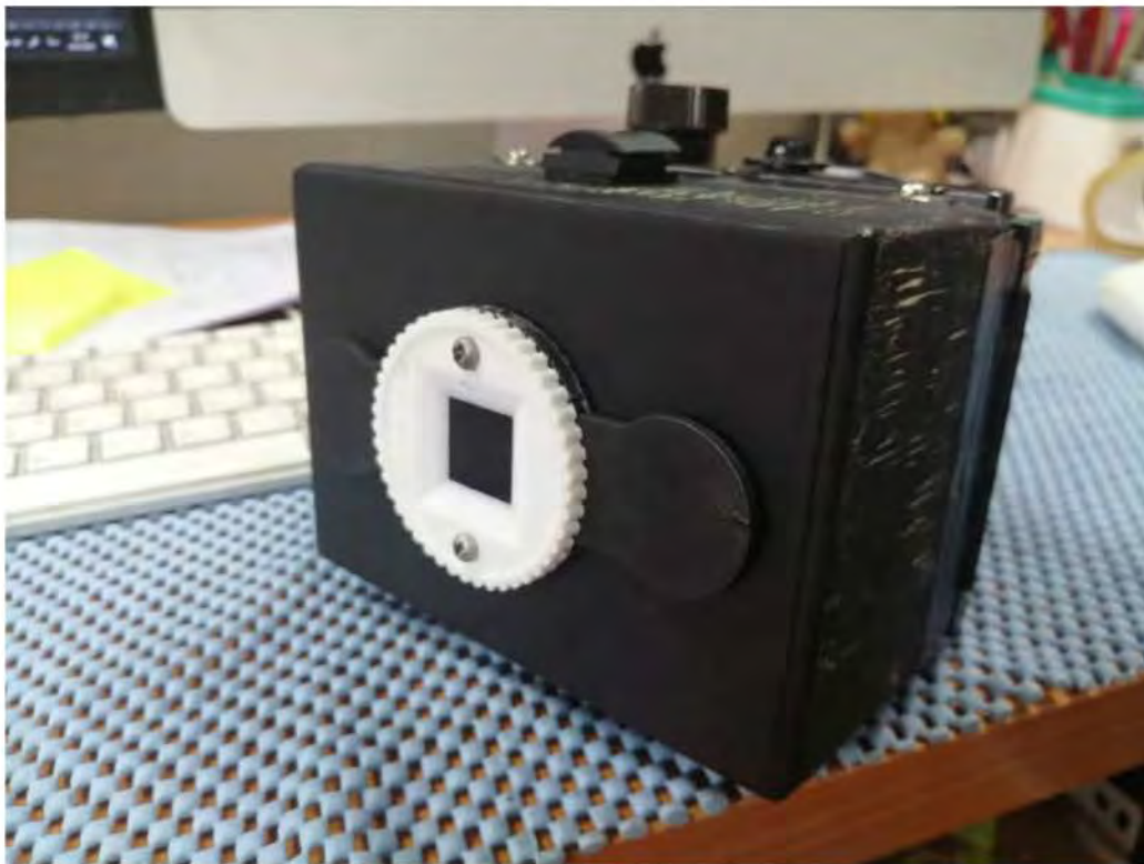
ภาพที่ 7 กล้องรูเข็มแบบประดิษฐ์เอง (© Sakkarin Suttisarn 02/8/2020)
