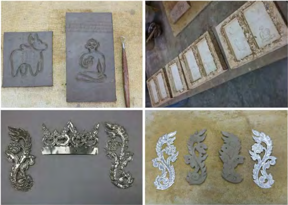
ภาพที่ 23 การสร้างแม่พิมพ์ของการทำกระเบื้องดินเผาและเครื่องประดับปานฮอย (© Pakit Bunsut 20/01/2018)
